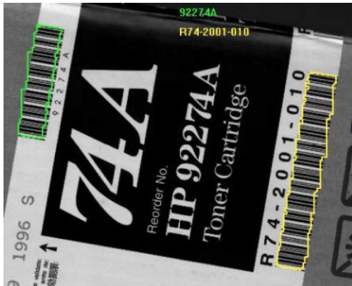
그림) 토너 카트리지의 두 개의 바코드를 자동으로 인식
