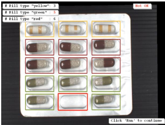
그림) 혼합 포장권 내용물 누락 검출
